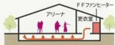
災害時の避難所として活用するため、更衣室に4台のF Fヒーターを設置し、更衣室を暖め、その暖気をアリーナ床下に送風して床冷えを防止します。
