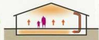
高天井のメディアセンター、多目的ホールの上部にたまった暖気をダクトで回収して、床下に循環させて暖房効率を高めます。
