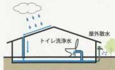
屋根に降った雨水を回収して、トイレ洗浄水や屋外散水に再利用します。
